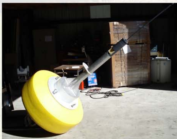
Fotografía de boya oceanográfica con sensores para medir pCO 2 del atmósfera adyacente y de la superficie del mar. Se muestra la antena a partir de la cual los datos son enviados vía satélite hacia los laboratorios de los participantes en los proyectos de investigación científica.
