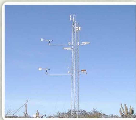
Torre de flujo de C en el CIBNOR
