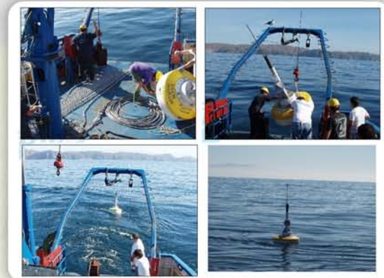
Preparación y lanzamiento de la boya oceanográfica a bordo del B/O Francisco de Ulloa del CICESE, frente a las costas de Bahía Magdalena, B.C.S.
