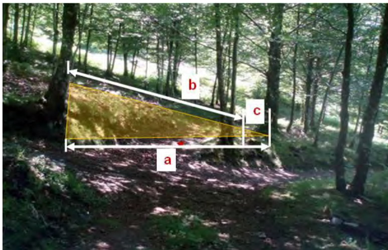
Figura 13. Efecto de la pendiente en la distancia horizontal. Distancia horizontal (a); distancia medida sobre un terreno con pendiente (b); diferencia entre la distancia horizontal y distancia medida sobre el terreno (c).
