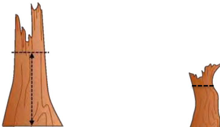
Figura A3.6. Criterios para la medición del diámetro normal en árboles quebrados
